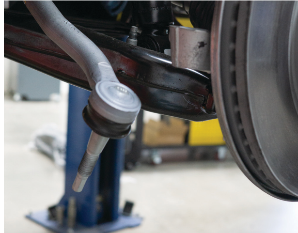
Fig. 4: Tie rod end link.
