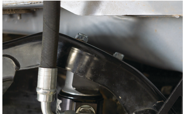
Fig. 33: Attach the top hat nuts.
