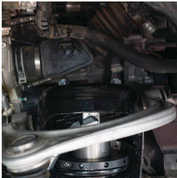
Fig. 14: Mount the top hat nuts.
