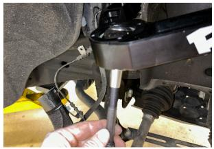
Fig. 17: Insert bolt.
