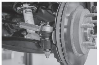
Fig. 3: Remove tie rod end nut.
