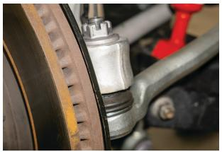
Fig. 12: Tie rod end link.
