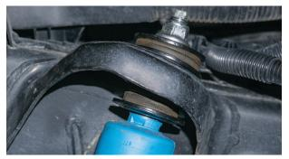
Fig. 17: Remove stem top nut.
