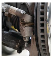
Fig. 10: Tie rod end link.
