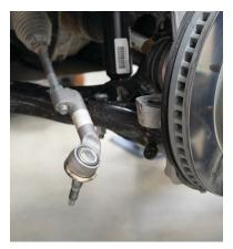
Fig. 2: Tie rod end link.
