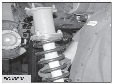
PHOTO SHOWS BASIC SPACER ON FACTORY STRUT
